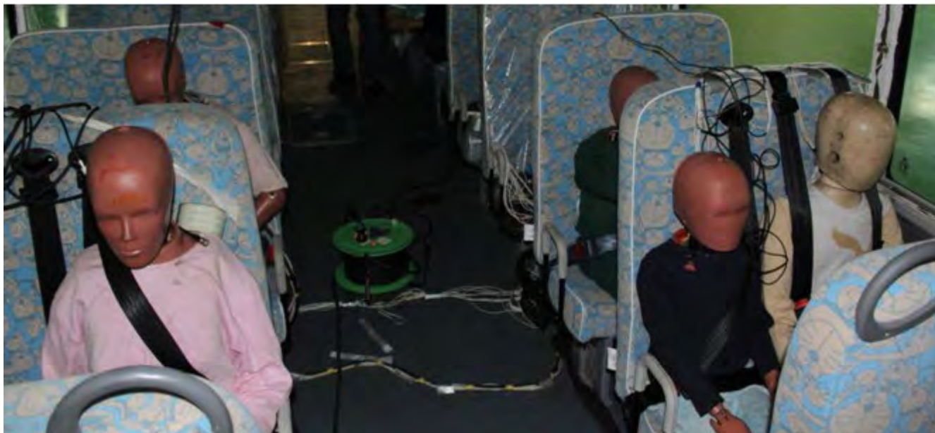
รูปที่ 8 การออกแบบที่นั่งของเด็กบนรถโรงเรียนให้จำกัดให้ผู้โดยสารเคลื่อนที่ในช่องของตนเอง (compartmentalization) และใช้เข็มขัดนิรภัยร่วมด้วย
