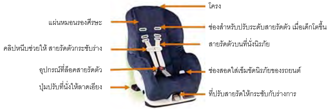
รูปที่ 5 ที่นั่งนิรภัยแบบหันหน้าไปด้านหน้าสำหรับเด็กอายุ 1-6 ปี ที่นั่งนิรภัยสำหรับเด็กวัยนี้มีสายรัดตัว 5 จุด วางหันหน้าไปทางหน้ารถ (forward facing seat)
