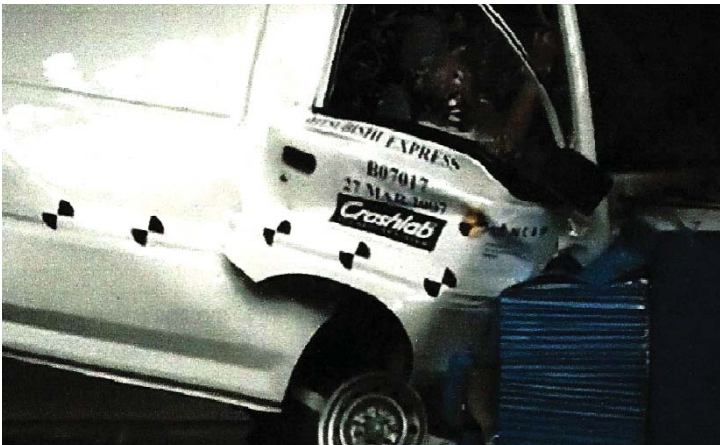
รูปที่ 4 การทดสอบการชน (crash test) ของรถตู้ของ Mitsubishi รุ่น Express (ที่มา: Crash_Test_Dummy_Man's photo stream http://www.flickr.com/photos/69220631@N02/ )
