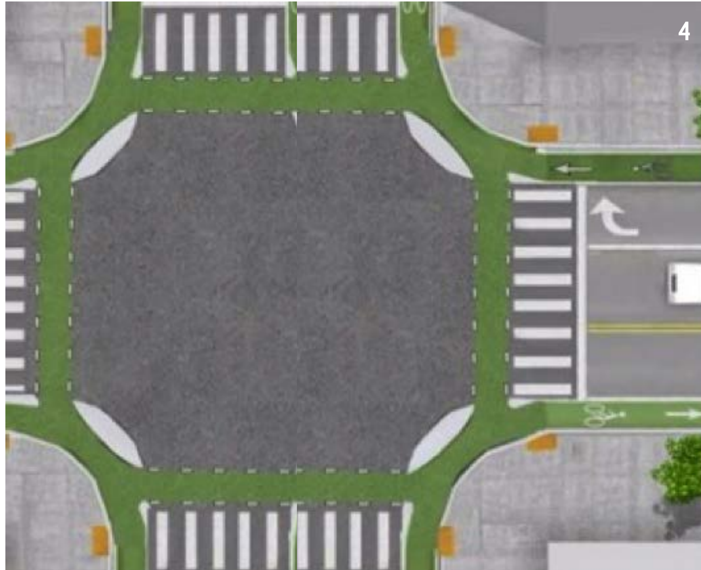
รูปที่ 4 การออกแบบทางแยกสำหรับจักรยานในประเทศเนเธอร์แลนด์เพื่อเพิ่มทัศนวิสัยและลดจุดขัดแย้ง ที่มา: http://www.knoxgardner.com/category/bicycling/page/2/
